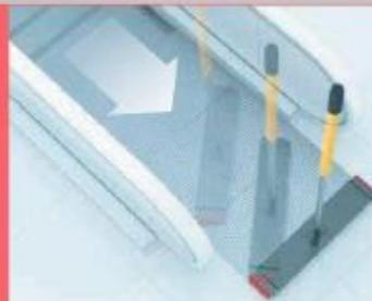
Place le système sur les marches en mouvement en l'alignant avec le peigne de l'escalator
